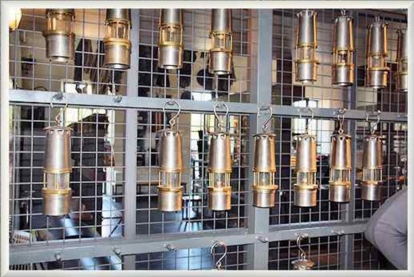
Lorsque les mineurs avaient revêtu leur tenue de travail, avant de prendre l'ascenseur, ils passaient par la lampisterie. Chaque ouvrier prenait une lampe qui portait un jeton numéroté. Il laissait ce jeton à la place de la lampe. Ceci permettait de contrôler, à la fin de la journée, la remontée du mineur si la lampe était en place. Cette dernière fonctionnait à l'essence minérale et avait peu de pouvoir éclairant mais surtout une utilité pour prévenir les coups de grisou : la flamme devait
